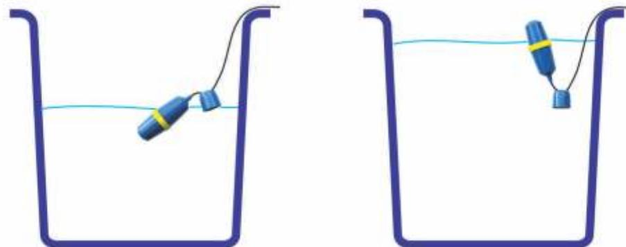
Colocando o peso no meio do reservatório, a bomba liga menos e a água do reservatório será sempre renovada.
